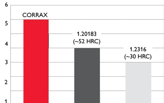
Corrax可以承受大部分腐蚀性塑料原料和稀酸的侵蚀。
