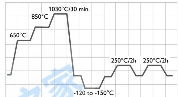
只在模具的尺寸稳定性要求高的情况下进行深冷处理。所得到的硬度为: 52-54 HRC。
